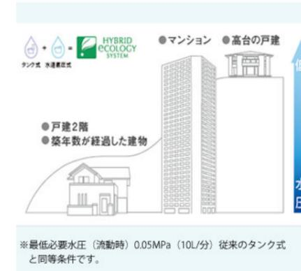
※最低必要水圧 (流動時) 0.05MPa (10L/分) 従来のタンク式と同等条件です。
